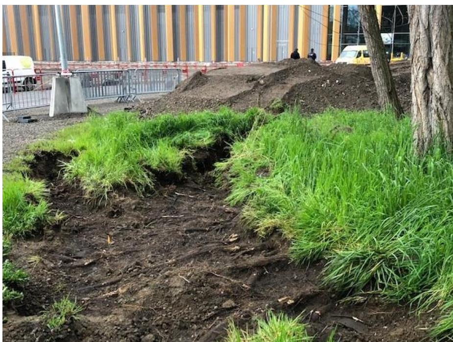
Photo d'un sondage racinaire sur des arbres en espace vert. Nous constatons la multiplicité des racines à -10 cm
