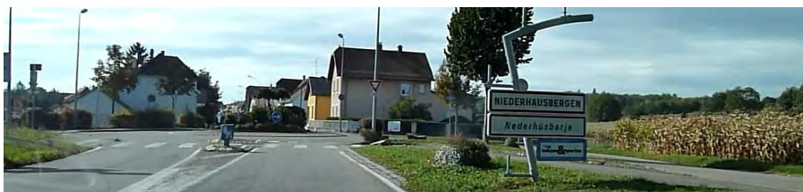
Vue 8 - Entrée d'agglomération de Niederhausbergen, le panneau d'entrée d'agglomération est positionné avant qu'on n'arrive dans l'espace sur lequel sont groupés des immeubles bâtis rapprochés
